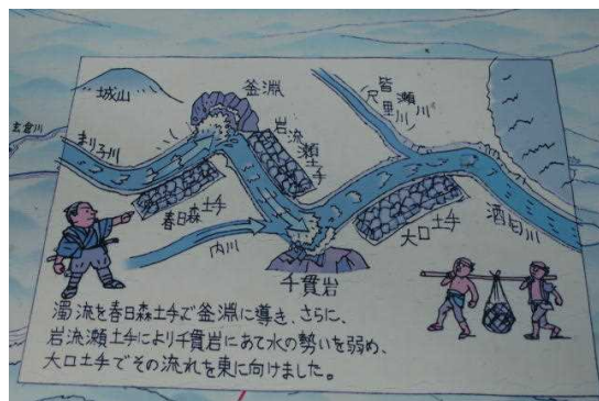
図007 Z字型にして水流を弱める工夫
