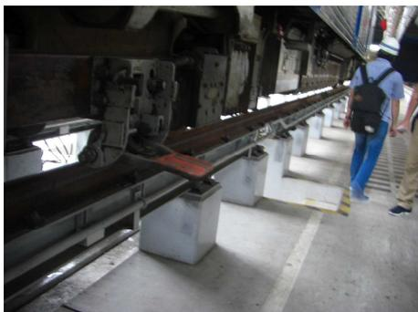
図4 地下鉄の給電部(オレンジの部分)
